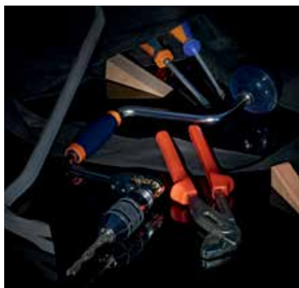
Рисунок справа: Инструменты для взлома в соответствии с классом защиты от взлома RC 3
